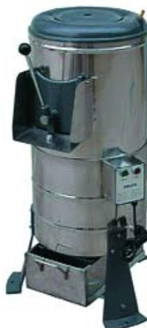
Корпус картофелечистки полностью выполнен из нержавеющей стали, что обеспечивает долговечность в эксплуатации, высокие гигиенические показатели и облегчает санитарную обработку. Удобство при использовании оборудования обеспечивает стационарное подключение к водопроводу и канализации. Картофелечистка рассчитана на загрузку 10 кг.
