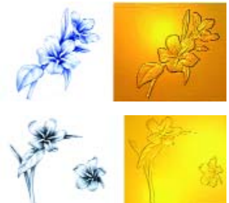
Рис. 3. На основе растровых эскизов пакет ArtCAM строит 3D-рельеф
