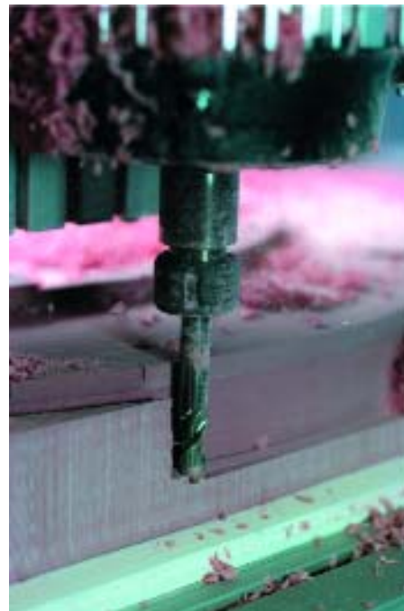
Рис. 7. Обработка модельной оснастки на станке с ЧПУ
