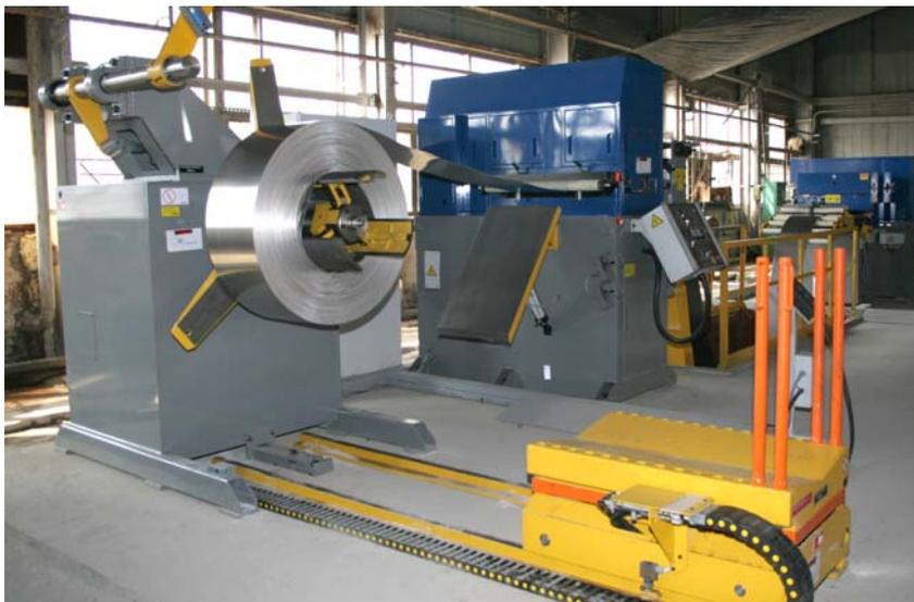
лоТорговой компании" стал запуск в действие импортной линии по поперечной резке лент. Линия позволяет получать заготовки прямоугольной формы оптимальных параметров - толщиной 0,3-3,0 мм, шириной 250-800 мм, длиной 300-3000 мм, которые могут быть без доработки направлены на такие виды посудного производства, как противни и крышки к ним, квадратные сковороды, лотки различного назначения, формы для выпечки и хранения продуктов, блок-формы для заморозки рыбы.
