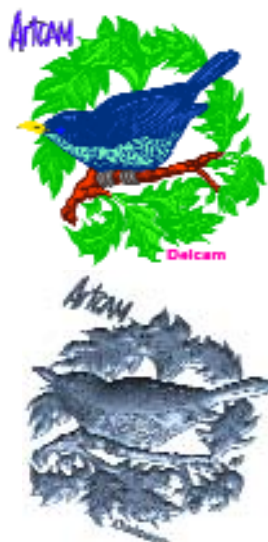
ArtCAM позволяет создавать трехмерные барельефы на основе эскизов и фотографий
