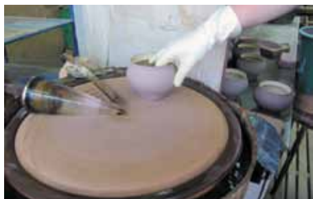
Замывка доньшка изделия после глазуровки на замывочном круге
