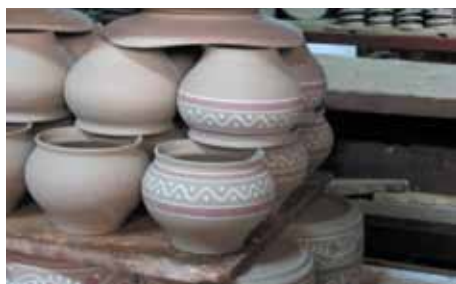
Загрузка «сырца» на первичный обжиг в туннельную печь
