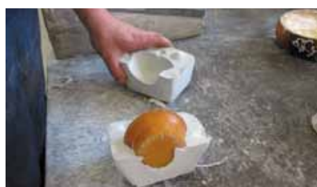
Маточная модель изделия для тиражирования гипсовых форм (для заливки шликером)
