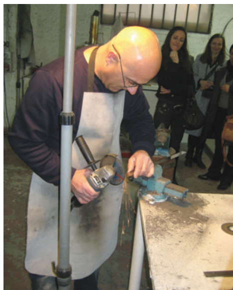
Процесс изготовления стального лезвия для ножа в мастерской частной компании
