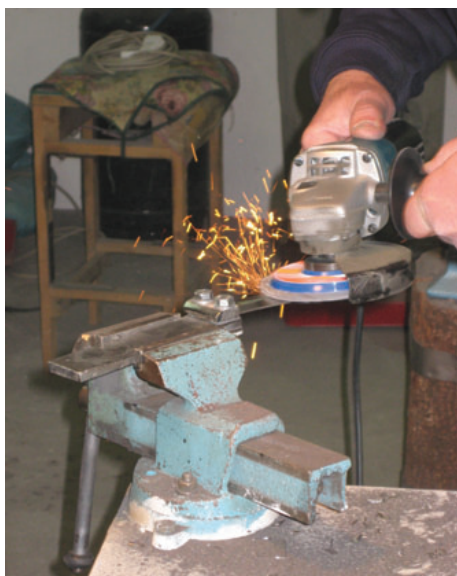
Процесс изготовления стального лезвия для ножа в мастерской частной компании
